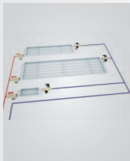
Fig. 2: Disposición de tuberías más sencilla, con regulación de caudal mixta de Zehnder (VSRK)
